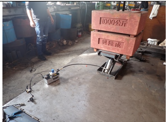
照片“D” 荷重測試
