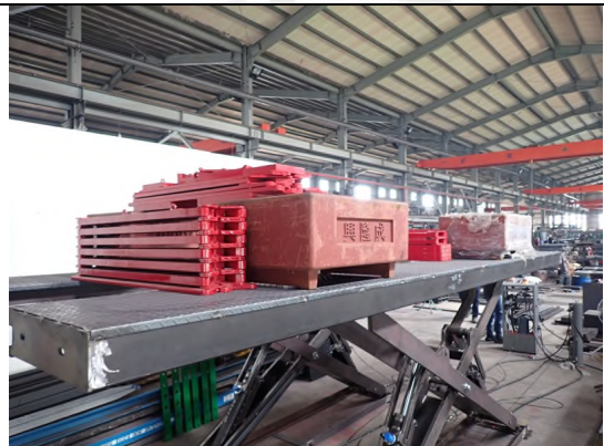
照片“F” 荷重測試
