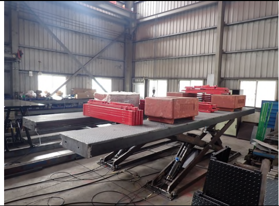
照片“D” 荷重測試
