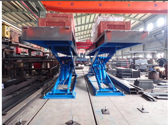
照片“F” 荷重測試
