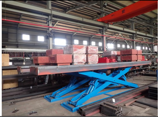
照片“D” 荷重測試
