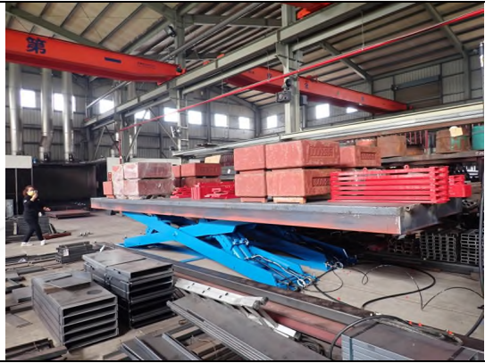
照片“B” 荷重測試
