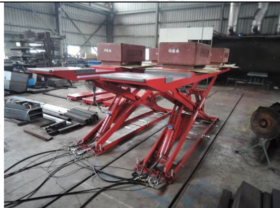
照片“D” 荷重測試
