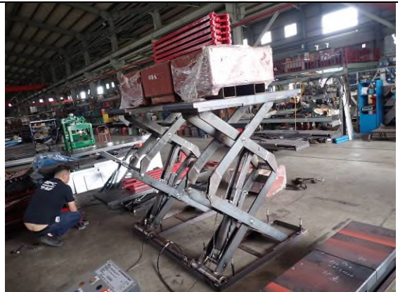
照片“D” 荷重測試
