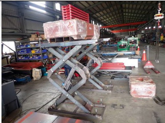
照片“C” 荷重測試
