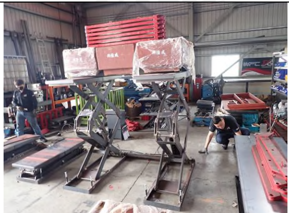
照片“F” 荷重測試
