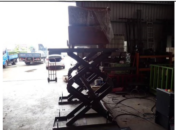
照片“F” 荷重測試
