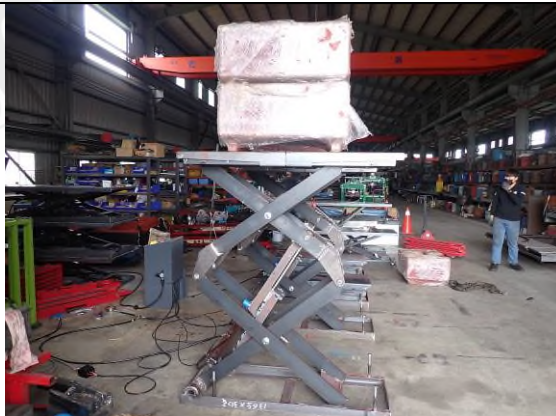
照片“C” 荷重測試
