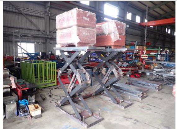
照片“D” 荷重測試
