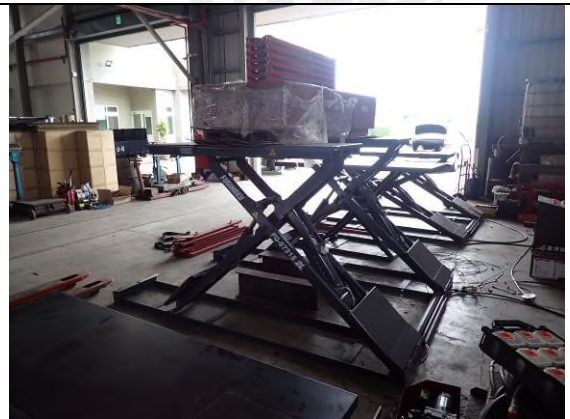
照片“F” 荷重測試
