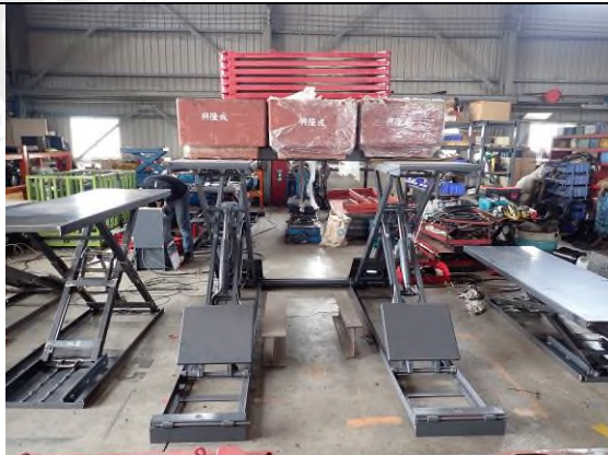
照片“C” 荷重測試
