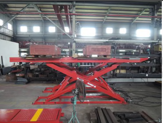
照片“E” 荷重測試
