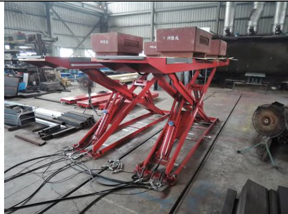
照片“D” 荷重測試
