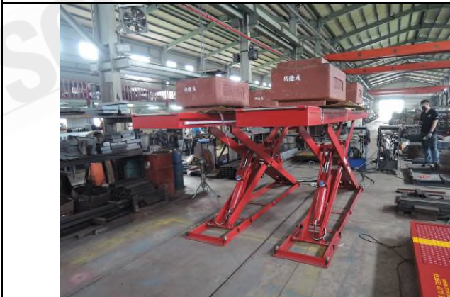
照片“T”荷重測試
