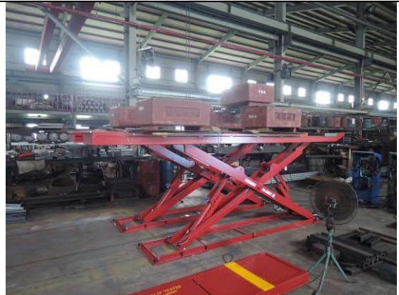
照片“F” 荷重測試
