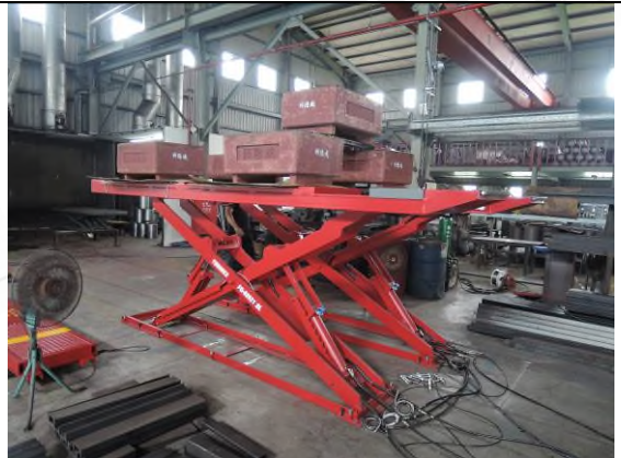
照片“H”荷重測試
