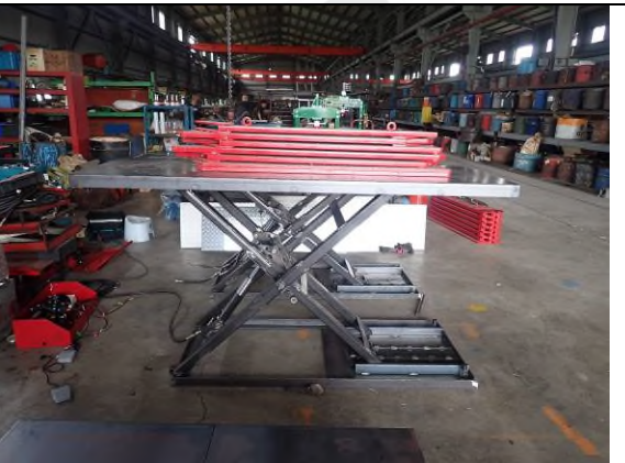
照片“D” 荷重測試
