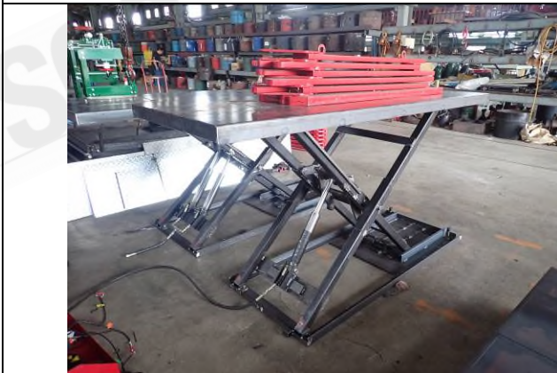
照片“E” 荷重測試
